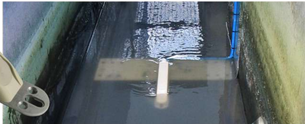
Capteur ultrason aérien pour la mesure de niveau, montage en voûte de conduite
