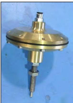
Notre gamme de modulateurs de pression est commercialisée avec un servomoteur hydraulique utilisé comme interface entre le contrôleur électronique et le stabilisateur de pression aval. Le servomoteur hydraulique est installé en lieu et place de la vis du pilote servant à définir la consigne de pression fixe de sortie du stabilisateur de pression aval.
